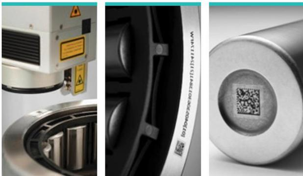
由于每个轴承都赋有耐久性的激光蚀刻 DataMatrix 二维码，即使在生产很久以后，所有利益相关者依然可以跟踪和管理每个单独的轴承系统及组件。
